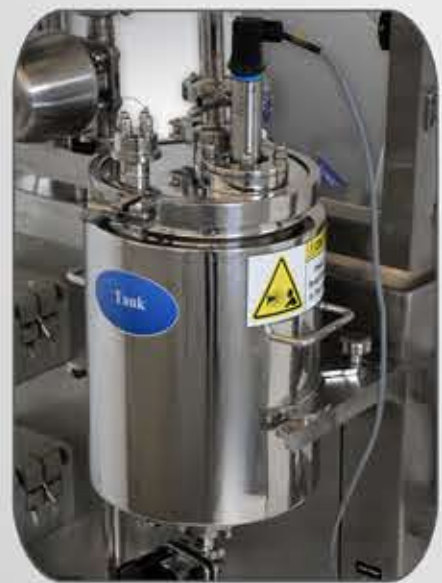
خزان محلي مصنوع من الستانلس ستيل AISI SS316L مزود بحساسات من الشركات الأوربية الرائدة Local tank made of AISI SS316L with instruments from european leaders suppliers
