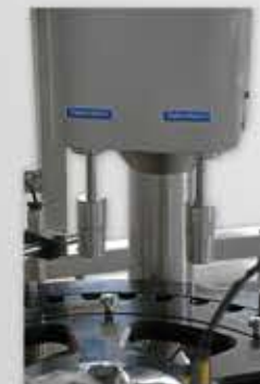
إغلاق الغطاء مع ضبط العزم بواسطة نظام سيرفو خطي دوراني متطور Capping head driven by linear/rotary servo system with tighten torque adjustment
