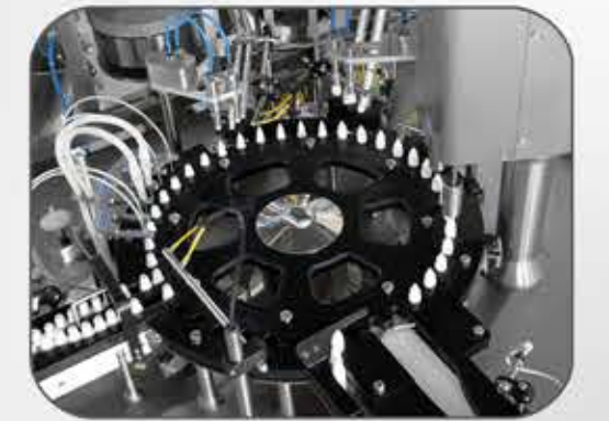
تم قيادة المقسم بواسطة نظام سيرفو متطور. Rotary Indexer driven by advanced servo system
