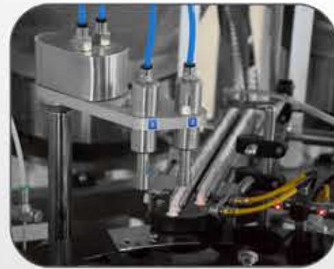
نظام سيرفو للتحكم بذراع زرع السدادات/ الأغطية الروبوتي Servo system to control robotic stoppers/caps insertion arm
