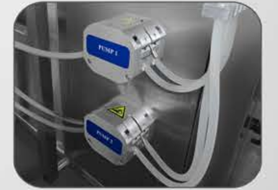
تعبئة باستخدام مضخة أنبوية أو مضخة مكبسية Filling by using peristaltic pump or piston pump
