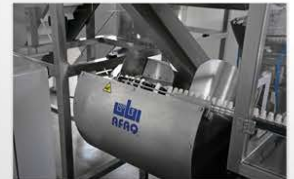
نظام تزويد عبوات متطور ذو كفاءة عالية Advanced, high-efficiency bottle unscrambler
