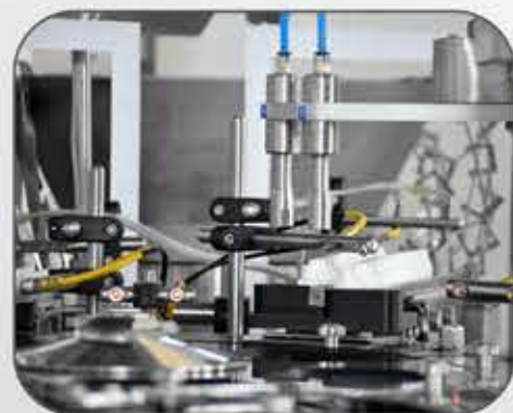
نظام سيرفو للتحكم بذراع زرع السدادات/ الأغطية الروبوتي Servo system to control robotic stoppers/caps insertion arm
