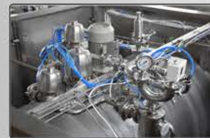
مؤشرات وحساسات من أفضل الشركات العالمية لمراقبة الاستخدامات (البخار العقيم، وسيط التسخين والتبريد، الهواء المضغوط) Sensors and instruments from the international leaders to monitor the system utilities (Pure steam, heating/cooling agent, compressed air)
