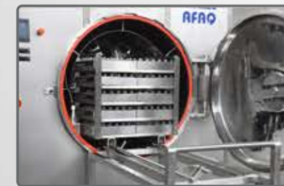
بوابات محكمة بواسطة موانع مصنوعة من السيليكون القابل للنفخ بواسطة الهواء المضغوط Gates are sealed with inflatable silicon gaskets
