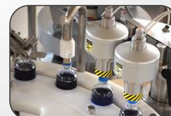
رأس إغلاق متطور ولا يحرر جزيئات Advance and low particl generating closing head
