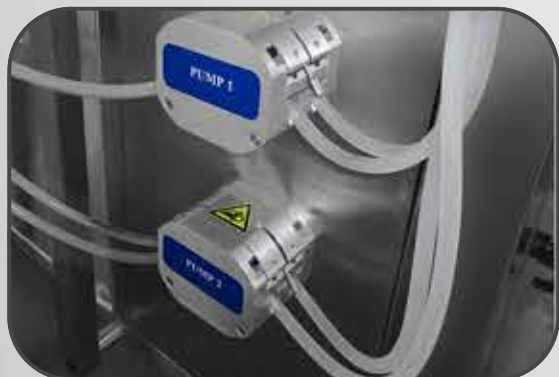
مضخة أنبوبية مضخة مكبسية Filling system (Peristaltic pump, metering pump)
