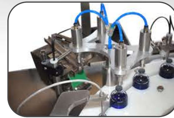
يتم تزويد السدادات بواسطة ذراع روبوتي يعمل بالهواء المضغوط Feeding bottles using advance and effective feeder
