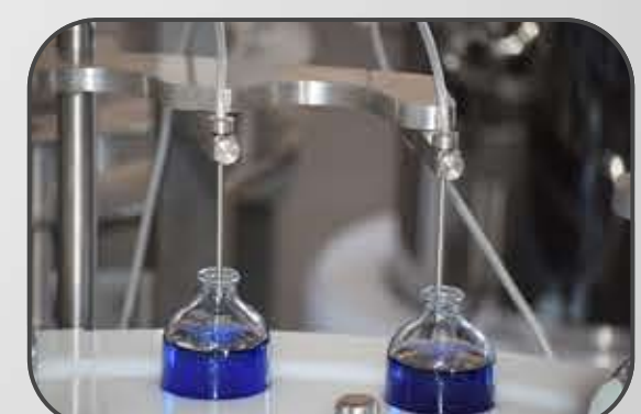
نفث آزوت قبل و/أو بعد التعبئة. N2 splash before or/and after filling
