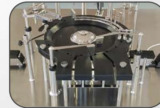
تتم قيادة المقسم الدوراني بواسطة نظام سيرفو متطور Rotary Indexer driven by advanced servo system
