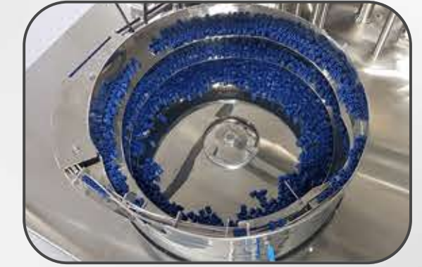
يتم تزويد العبوات والسدادات بواسطة مزودات متطورة ذات كفاءة عالية Feeding bottles and stoppers by using advance and effective feeder
