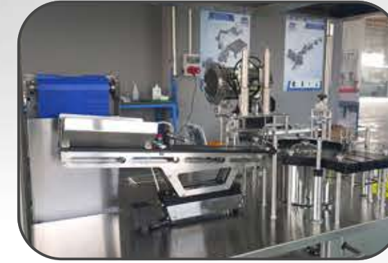
يتم تزويد العبوات والسدادات بواسطة مزودات متطورة ذات كفاءة عالية Feeding bottles and stoppers by using advance and effective feeder
