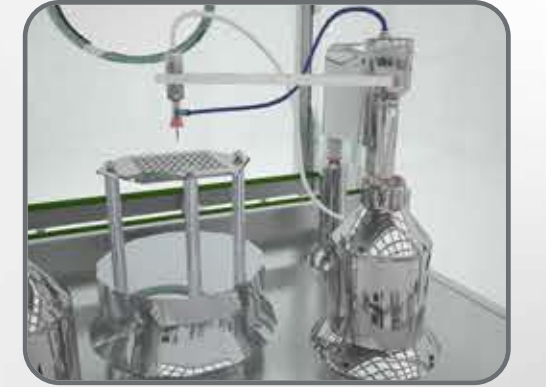
ذراع روبوتية مقادة بواسطة محركات سيرفو للتحكم بحركة فوهة التعبئة Robot arm driven by servo system to control the motion of the filling nozzle
