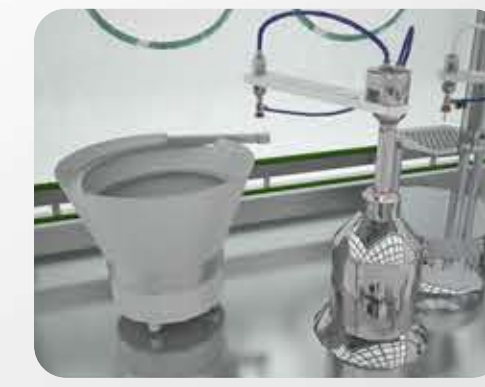
ذراع روبوتية مقادة بواسطة محركات سيرفو للتحكم بحركة حامل السدادات Robot arm driven by servo system to control the motion of the stoppering head
