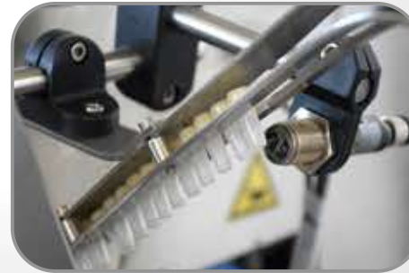
تلقيم السدادة بشكل آلي عن طريق رجالات Automatic stopper feeder
