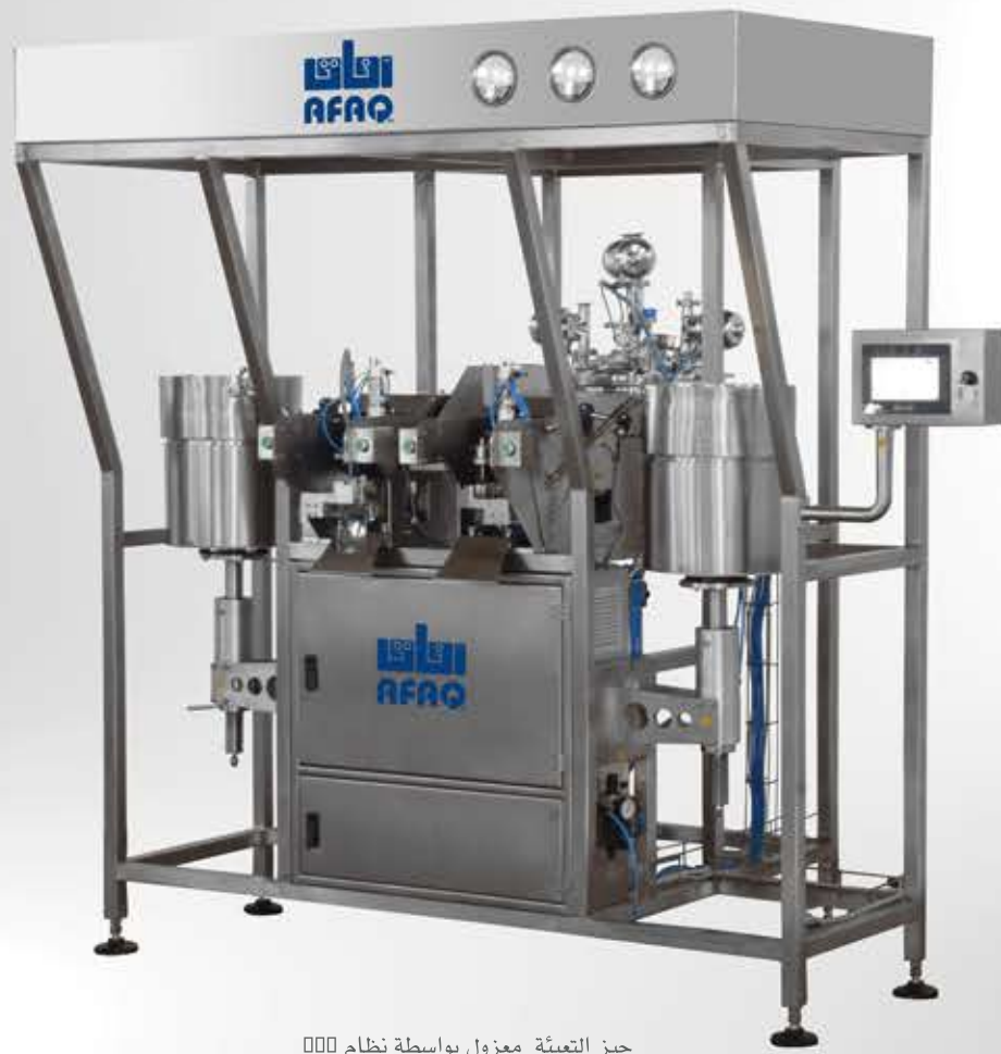
حيز التعبئة معزول بواسطة نظام LAF Filling area isolated by LAF
