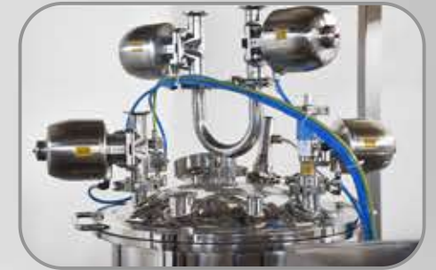
خزان محلي مصنوع من الستانليس ستيل Local Tank made of AISI SS316L
