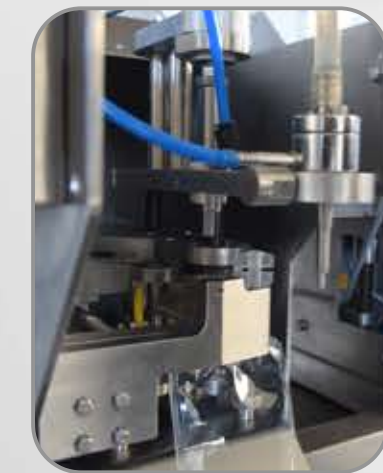
تلقيم السدادة Stopper insertion
