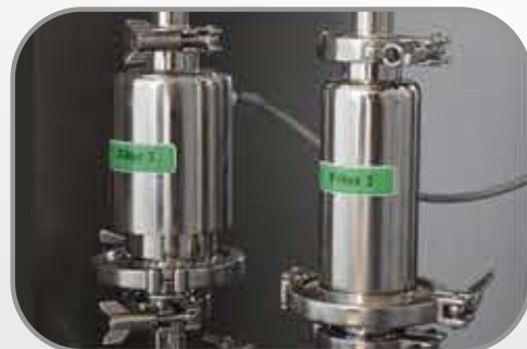
فتحة تزويد نيتروجين مع مرشح جرثومي لسحب الأوكسجين المتحل ضمن المحلول Nitrogen inlet for purging with microbial filter
