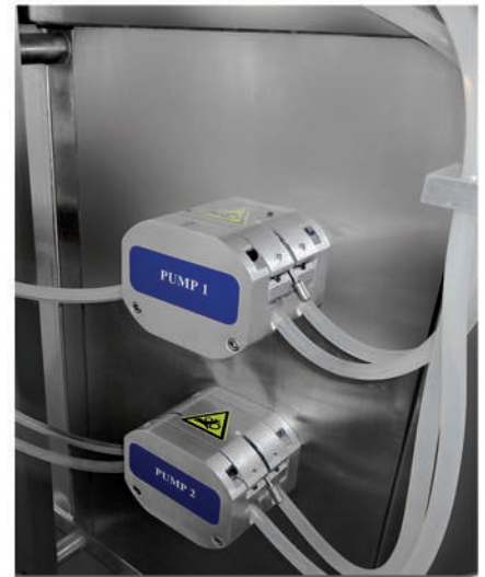
الشكل 2- رأس المضخة الأنبوبية المدمج في آلة تعبئة السوائل
